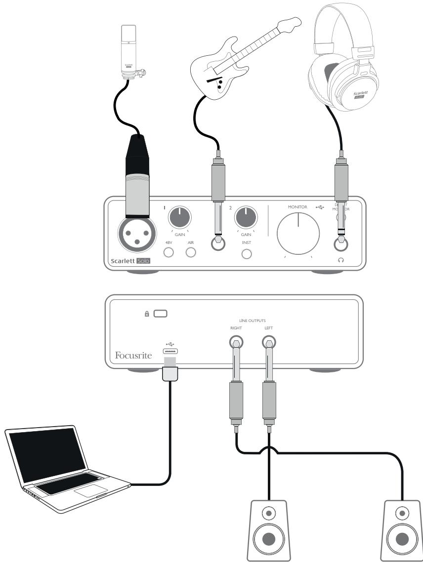
В данном примере настройки иллюстрируется самая распространенная конфигурация для записи с использованием программного обеспечения DAW на компьютере Mac или ПК. Здесь вокал может записываться в приложении для записи через вход 1, а гитара — через вход 2, при этом осуществляется контрольное прослушивание воспроизводимой записи через наушники.
