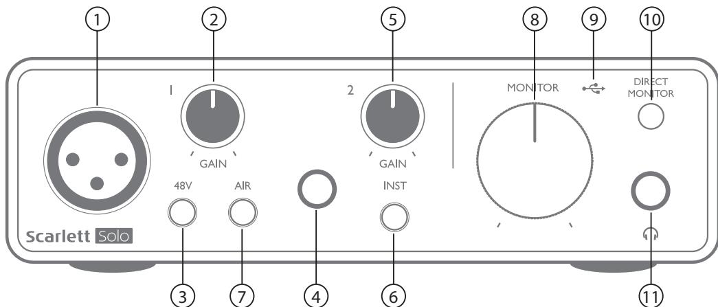
На передней панели располагаются входные разъемы для подачи сигналов микрофона и линейных сигналов/сигналов музыкальных инструментов, а также органы регулирования входного усиления и управления функцией мониторинга.
