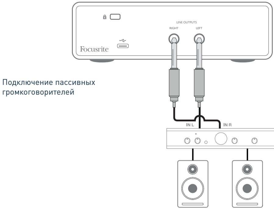
Линейные выходы представляют собой электрически симметричные 3-контактные гнезда (TRS)  $\frac{1}{4}$  дюйма (6,35 мм). Типовые бытовые усилители (Hi-Fi) и маломощные мониторы с автономным питанием имеют несимметричные входы, выполненные в виде гнезд типа RCA или 3-контактных штекеров 3,5 мм, предназначенных для непосредственного подключения к компьютеру. В обоих случаях следует использовать подходящий соединительный кабель со штекерами на одном из концов.
