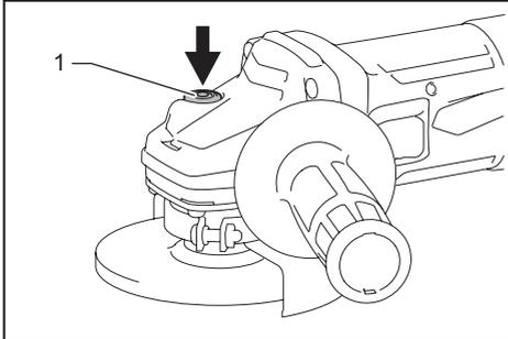
► 1. Фиксатор вала
