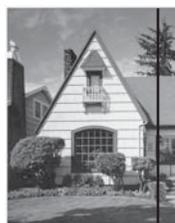
Если на стеклянной планке осталось пятно грязи или корректора, на отсканированном образце видна вертикальная линия.
